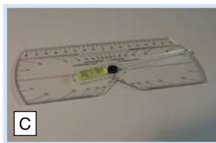
C: Inclinometro a bolla di d'Osualdo – preciso e compliant nella determinazione dell'ART (angolo di rotazione del tronco)
